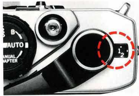
⑦ Armer et déclencher "à blanc" jusqu'à ce que le compteur indique "1".
